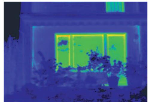
Après le montage soigneux de nouvelles fenêtres Corona CT 70, la thermographie démontre l'avantage énergétique élevé de l'investissement. La perte d'énergie initiale est ainsi presque totalement compensée.
